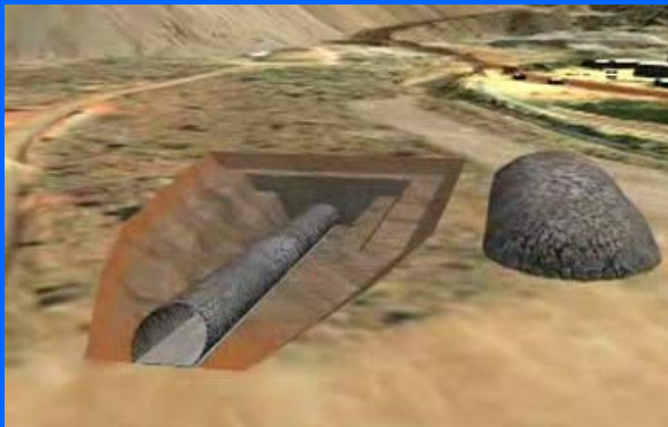
Izrada ulaza u niskop
